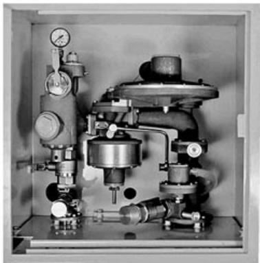
Шкафные газорегуляторные установки предназначены для снижения среднего или высокого входного давления природного газа до низкого, автоматического поддержания заданного давления на выходе в установленных пределах, очистки газа фильтром тонкой очистки, кратковременного сброса избыточного давления газа в сбросную линию, а также для автоматического отключения подачи газа при аварийном повышении или понижении выходного давления сверх допустимых заданных значений.
